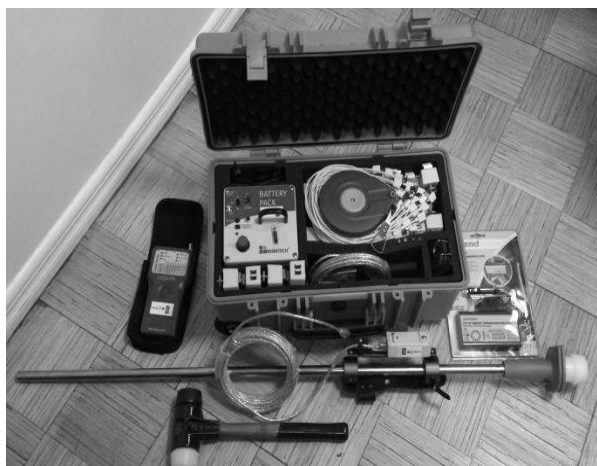
Рис. 3. Внешний вид прибора Arbotom® и томограмма ствола
